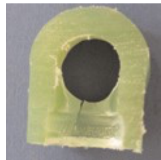
Risse durch Versprödung am T-Stück
