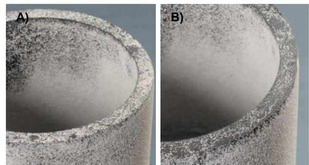
**FIG. 14 EXAMPLES OF SAND CONTAMINATION LEVELS: A) HEAVY AND B) LIGHT**
