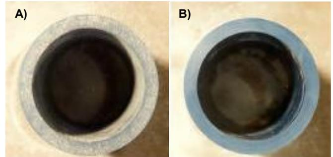
**FIG. 12 EXAMPLES OF TALC CONTAMINATION LEVELS: A) HEAVY AND B) LIGHT**
