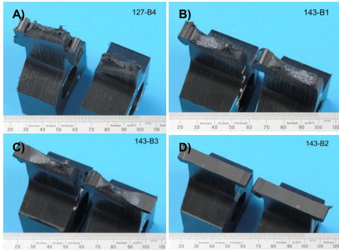
**FIG. 19 FAILURE MODES FOR HIGH SPEED TENSILE IMPACT TEST: A) IN PARENT PIPE, B) DUCTILE, C) MIXED AND D) BRITTLE**
